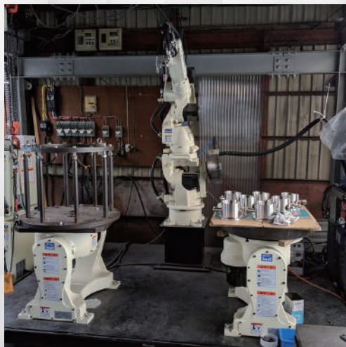
ロボット溶接機
