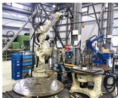
TIG溶接機(手前)とプラズマ溶接機(奥)
